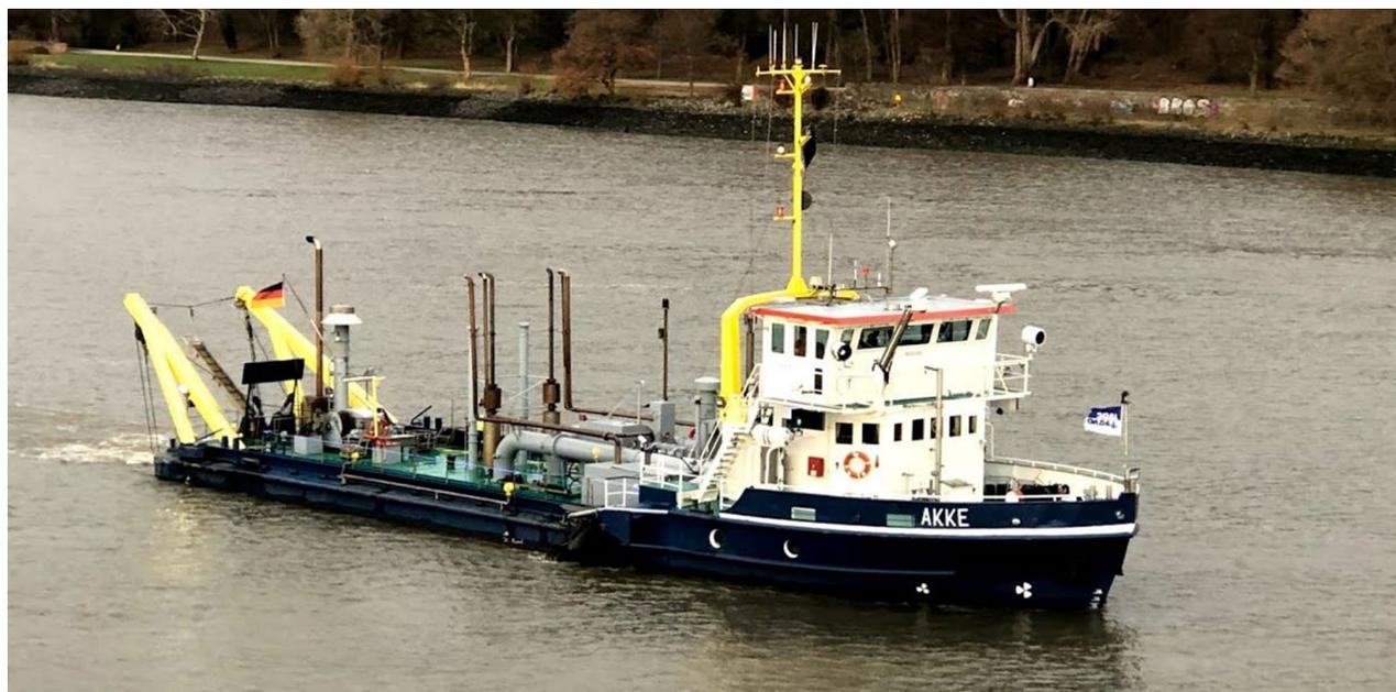
Abbildung 8: Das in Hamburg bewährte Wasserinjektionsgerät Akke. (Foto: Christian Jonas).
